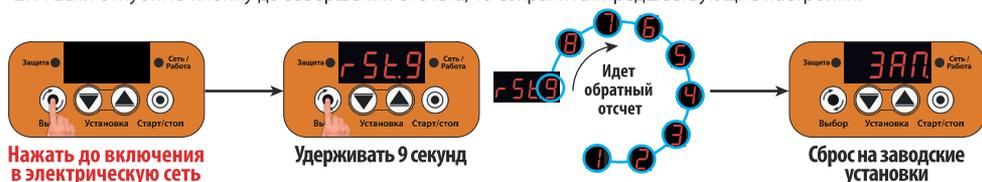
Нажать до включения в электрическую сеть
