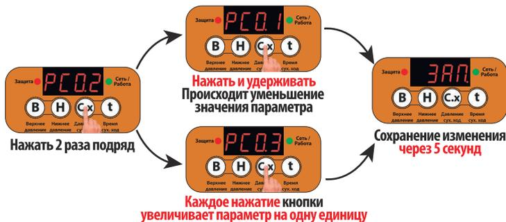
21.4 “tXXX” – задержка срабатывания защиты от “сухого хода” в секундах. Если во время работы насоса давление в системе водоснабжения не поднимется выше уровня “РСХ.X” до истечения времени “XXX”, то РДЭ отключит насос по функции защиты от сухого хода. На дисплее при этом отображается **C-E**. Для **принудительного включения** насоса **нажмите любую кнопку**. Рекомендуемые установки:
