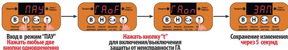
21.6 “Au.on/Au.oF” – включение/выключение звуковой сигнализации аварийных режимов. Заводская установка – “Au.on”.
